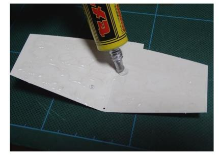
⑤主翼と主翼補強を接着する
