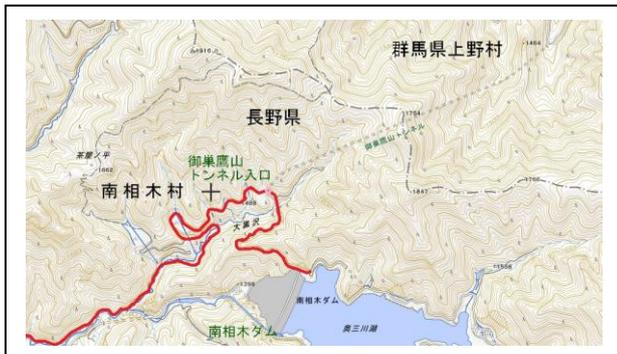
地図で見たら群馬県上野村まで行っており、神流川発電所との往來用トンネルのようだ。トンネルの先に神流川発電所さらに上野ダムがあり、南相木ダムを加え揚水式(発電所)になっている。
