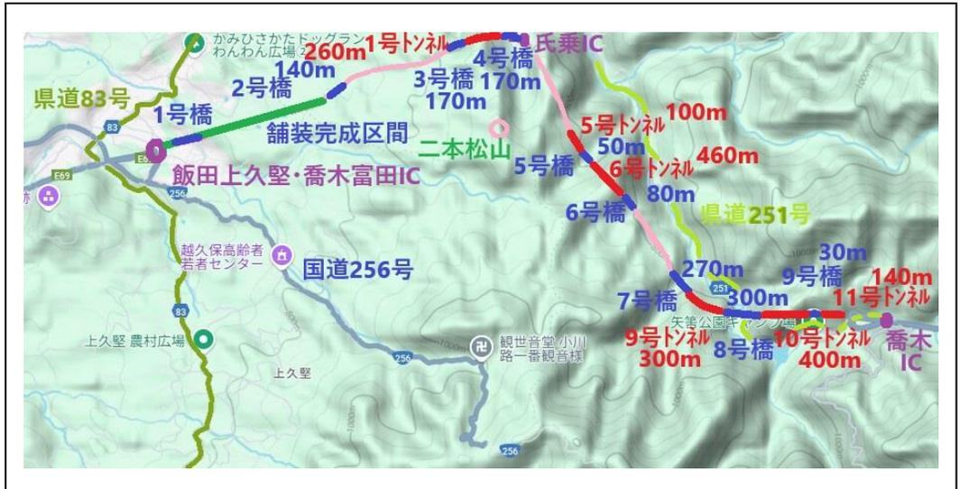
た。中間的な進捗状況として、道は舗装完成・橋はなんらかの橋が渡る・トンネルは貫通をとすると、道は図にある区間が 2022 年 4 月に、橋は、1 号橋が 2021 年 3 月、(3 号橋がかけ始め)、6 号橋が 2024 年 9 月に、トンネルは、(2 号掘り始め)、(6 号が 55%)、11 号が 2022 年 9 月に貫通し、進んでいる。
